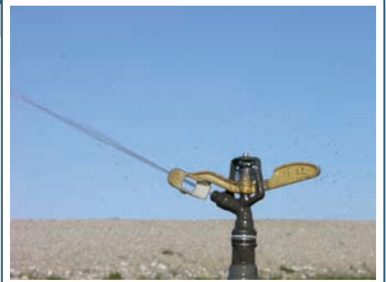
Inspecter les buses d'asperseurs tous les ans. Mesurer leur ouverture pour vérifier si elle est usée, et remplacer la pièce si elle dépasse les limites de tolérance.
