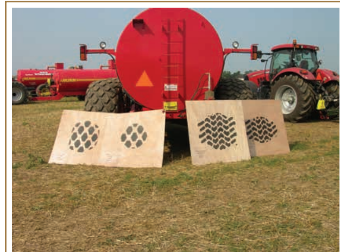
Lorsque les pneus des véhicules d'épandage sont gonflés à faible pression, la surface de contact avec le sol s'accroît, ce qui contribue à diminuer le risque de compactage.
