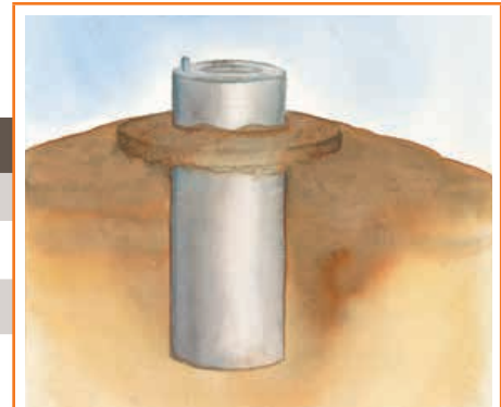
Les conteneurs d'élimination sont des contenants étanches à l'épreuve des charognards dans lesquels les cadavres d'animaux peuvent se décomposer naturellement.
